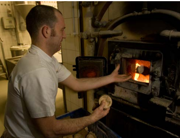
Beschickung des alten Holzbrikett-Backofens
